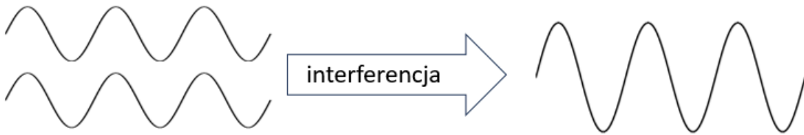
Rys. 5. Interferencja fal mechanicznych w tych samych fazach ruchu. Powstaje fala wypadkowa o zsumowanej amplitudzie i energii.
